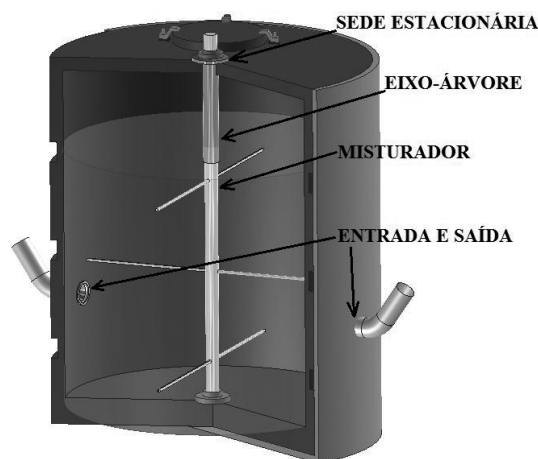
Figura 1 – Aplicação de face estacionária em biorreator contínuo com misturador Fonte: Souza, (2010).
